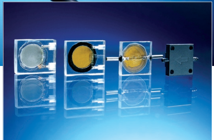
Abb. 2: Der Weg vom Prototypen (l.) bis zum serienreifen Produkt (r.) ist lang. Mit winzigen Mikropumpen etablieren sich jetzt die ersten mikrofluidischen Massen-Produkte im Markt.
