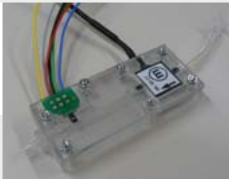
Die geregelte Mikropumpe ist mit intelligenter Elektronik ausgerüstet
